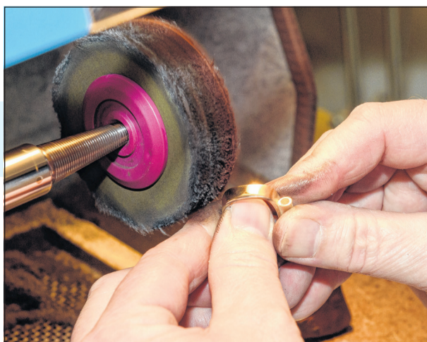
Beim Polieren verleiht die Goldschmiedin alten und neuen Schmuckstücken einen neuen Glanz.
